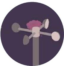
Podemos medir la velocidad del viento con un anemómetro. El viento sopla sobre la parte superior del anemómetro y cuando este gira, un dispositivo calcula su velocidad y la convierte en velocidad del viento. Podemos medir la dirección del viento con una veleta. Una veleta también gira y apunta en la dirección de donde viene el viento.
